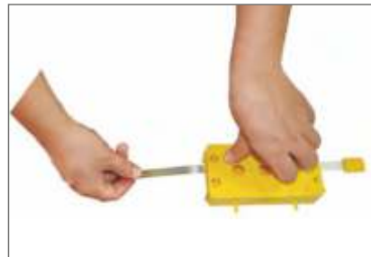
4. Çelik kuralı: Cetvel, rezonans kutusunu kullanarak masanın kenarına bastırarak, çelik bir askı parçası, sesi duyabilir, ve cetvelin titreşimi görülebilir.
