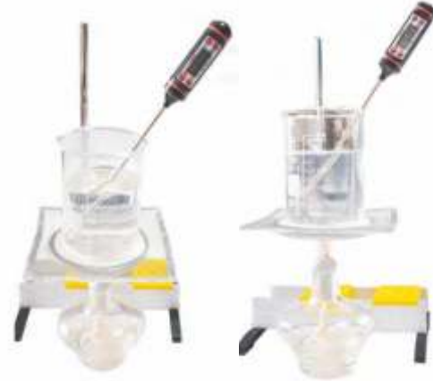
3. Suyun kaynama gözlemi: Suyu kaynama noktasına kadar ısıtın, gazlaştırma olgusunu (aslında, su buharının yoğunlaşmasını), termometrenin gözlemini, belirli sabit bir sıcaklığı görebilirsiniz.
